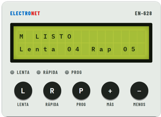
Hongo rearmado: la máquina queda parada, en LISTO .
