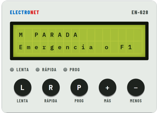
Se pulsó el hongo con la máquina en lenta.
