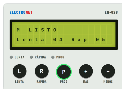
Paso 4: PROG guarda; en reposo se ve Lenta 04 .
