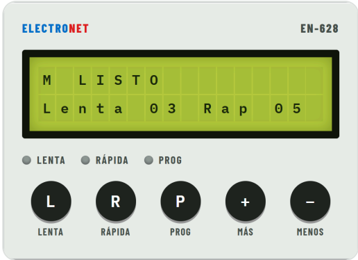
Pantalla, luces LENTA · RÁPIDA · PROG y los cinco pulsadores.
