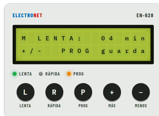
Pasos 2 y 3: la lenta en 4 minutos. PROG fija, LENTA parpadeando.
